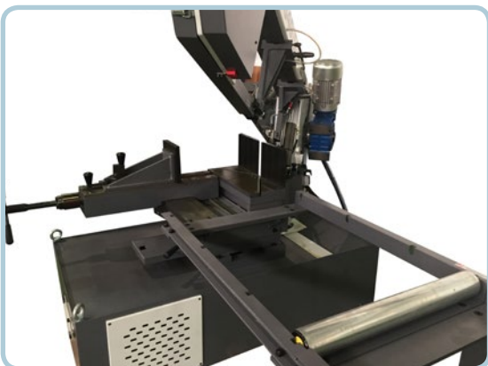
Rodillos extraíbles. / Removable rollers.
