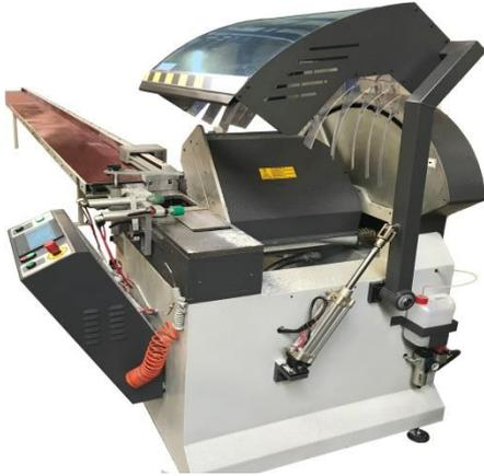
FRONT-450 AAG CNC Máquina automática de corte de aluminio con programación de longitud y grados  $-22,5^{\circ}$  /  $-45^{\circ}$  /  $90^{\circ}$  /  $+45^{\circ}$
