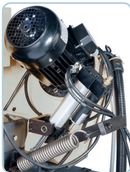
Bajada hidráulica (K-300-M-D/I-BH) Hydraulic descent (K-300-M-D/I-BH)
